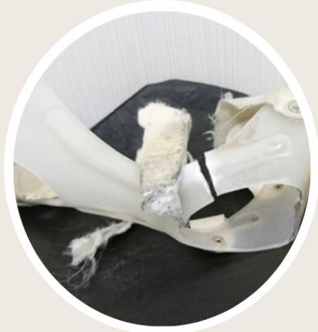
一部破損している ベルトがボロボロになっている
